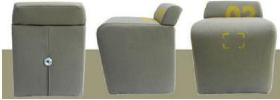
صورة رقم (٣) الكرسي الروبوتى مصمم لتتبع الأفراد المستخدمين من خلال بطاقة ذكية مغنطة Jason Chen : “RFID Robotic Chair Follows You Around For Constant Seating” – Gizmodo – 2008.
